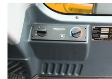
Heizung mit leistungsfähigem, 3-stufigen Gebläse
